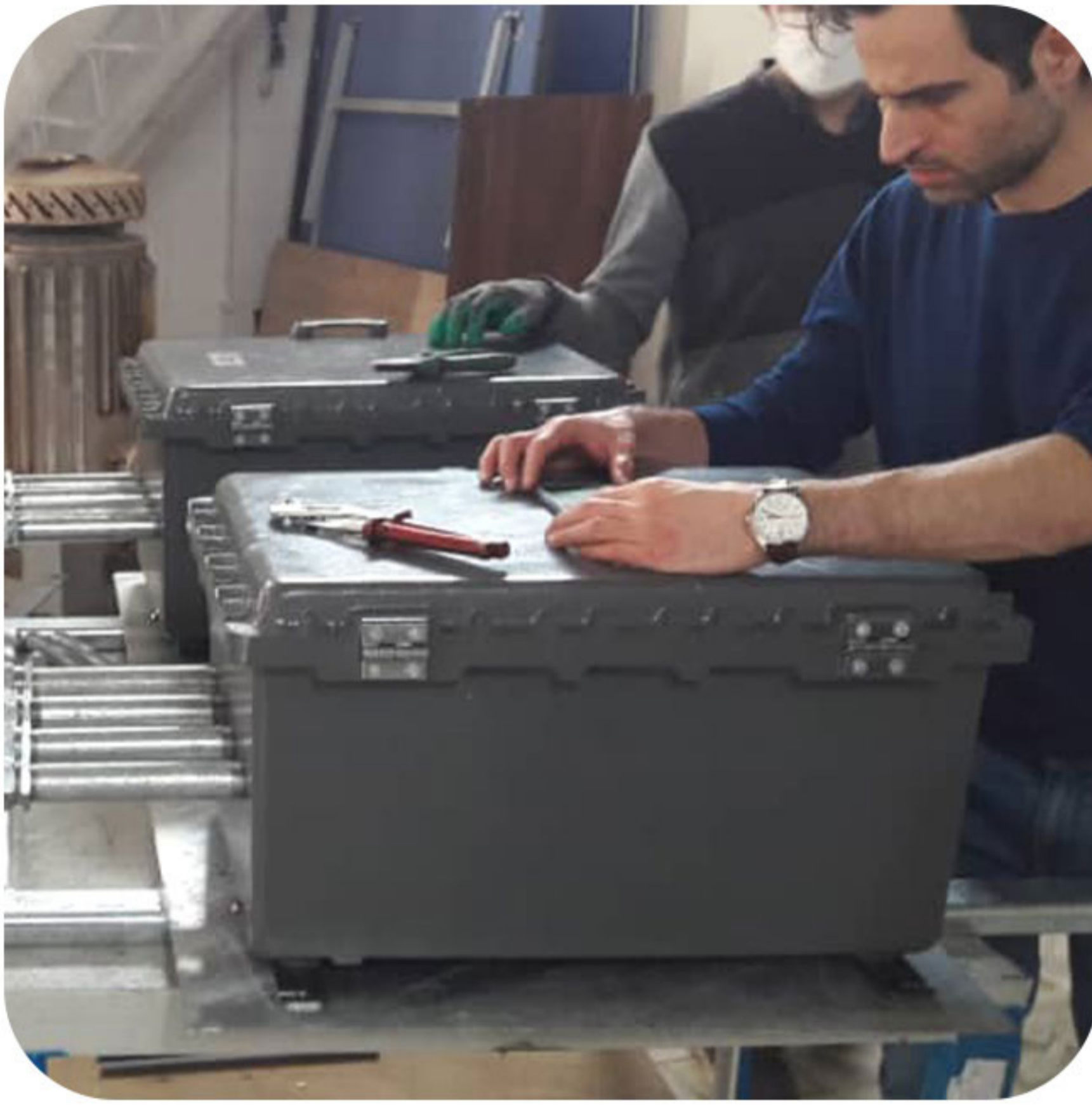
طراحی، تامین و مونتاژ CONTROL STATION های ضد انفجار میدان نفتی دشت آزادگان.
