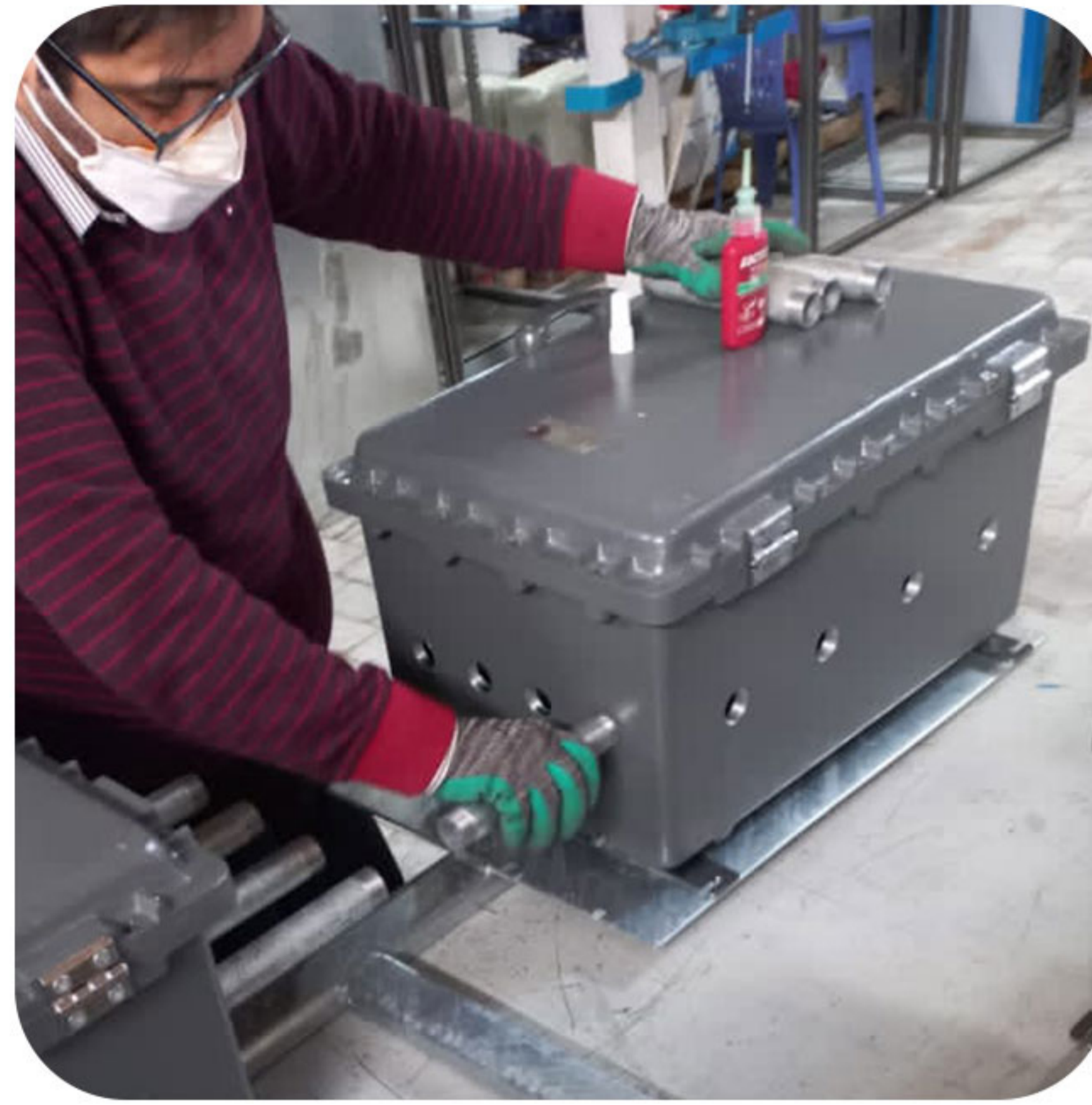
طراحی، تامین و مونتاژ CONTROL STATION های ضد انفجار میدان نفتی دشت آزادگان.
